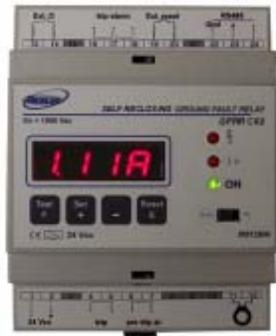
Sur les réseaux de distribution BT avec le neutre à la terre, le relais **GFRR** assure la protection différentielle et le réenclenchement automatique. Il reçoit un signal proportionnel à la valeur de la fuite provenant d'un tore installé sur le départ à protéger, et donne l'ordre de déclenchement au disjoncteur concerné si le défaut a atteint la valeur paramétrée du seuil (dEF) et de la temporisation (tdEF).
