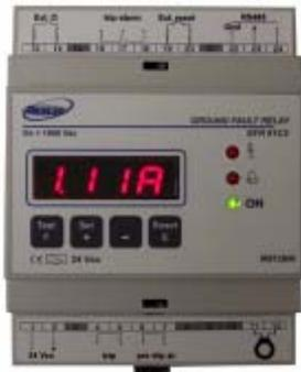
Dans les réseaux de distribution BT avec le neutre à la terre, les relais différentiels **GFR C0x** assurent la protection contre les défauts à la terre. Il reçoit un signal proportionnel à la valeur de la fuite provenant d'un tore installé sur le départ à protéger, et donne l'ordre de déclenchement au disjoncteur concerné si le défaut a atteint la valeur paramétrée du seuil.
